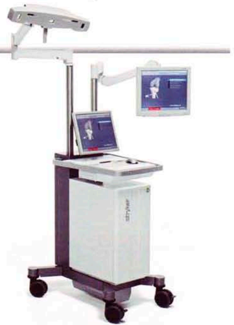
Über das Stryker-Navigationssystem kann der Chirurg anhand kinematischer Daten ein Gelenk sicher integrieren Bild: Erdmann
